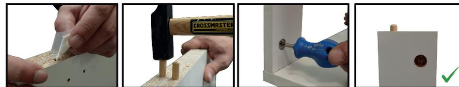
La caja minifix debe ser colocada con la flecha hacia afuera. Los tarugos van colocados y encolados en los perfiles de las piezas. No colocarlos en la perforación para los minifix.
