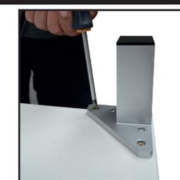
9. Colocamos las patas en las esquinas dejando un margen de 1 cm por lado, revisamos que no se superponga con los tornillos armamueble. Atornillamos utilizando 4 tornillos 4x16 por pata.
