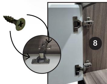
8. Atornillar las bisagras a la puerta. Regular la posición de las puertas ajustando los tornillos de regulación de bisagras.
