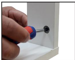
6. Ajustar caja minifix con ayuda de un destornillador.
