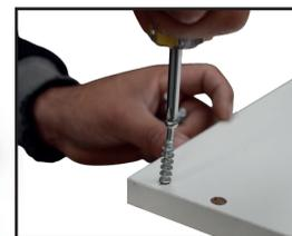
3. En la pieza del lateral, atornillar el perno minifix agujero superior.
