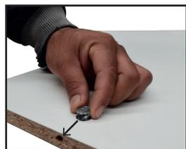
2. Colocar el agujero que tiene la caja minifix mirando hacia el agujero lateral en la pieza.
