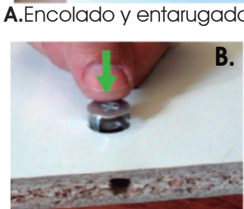
B. Colocación de los minifix
