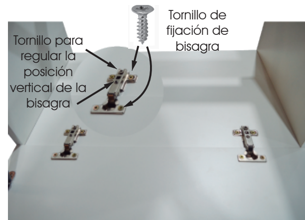
A. Regule la posición de las puertas ajustando los tornillos de regulación de las bisagras.
