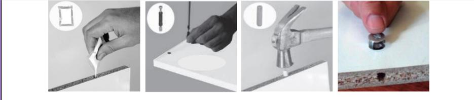
Colocación de los Pernos Minifix. Encolado y colocación de Tarugos.
