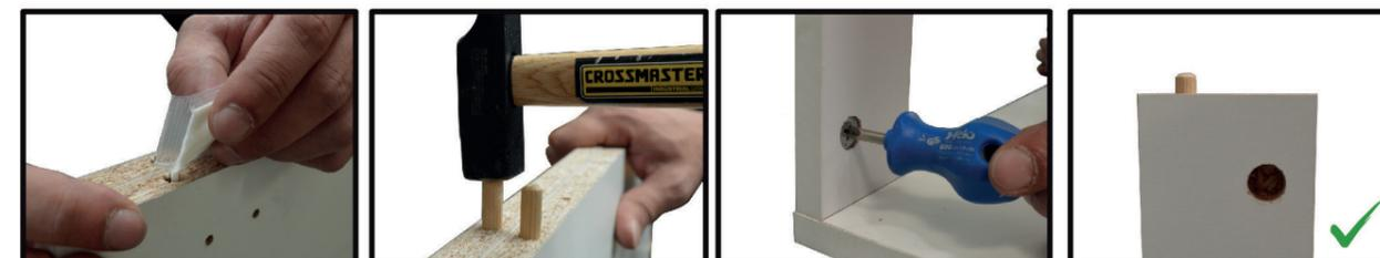
La caja minifix debe ser colocada con la flecha hacia afuera. Los tarugos van colocados y encolados en los perfiles de las piezas. No colocarlos en la perforación para los minifix.
